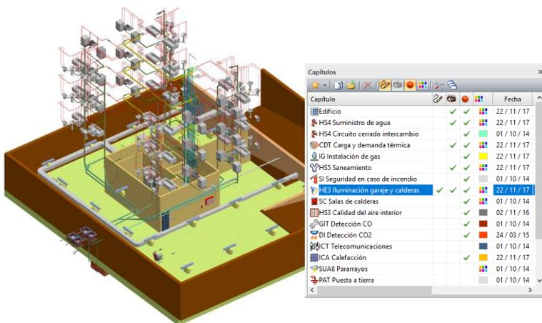
Con Tekton3D, la definición geométrica o levantamiento del edificio se realiza una sola vez (a través de Allplan, de intercambio IFC, o mediante plantillas DXF/DWG) y posteriormente se usa como marco para diseñar y dimensionar en capítulos independientes las distintas instalaciones.
