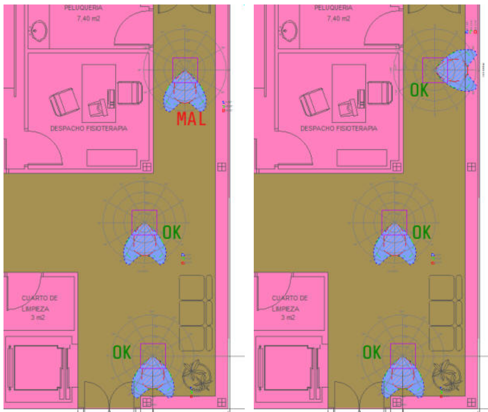
Figura 89: Visualización de los diagramas polares para orientar correctamente las luminarias.
